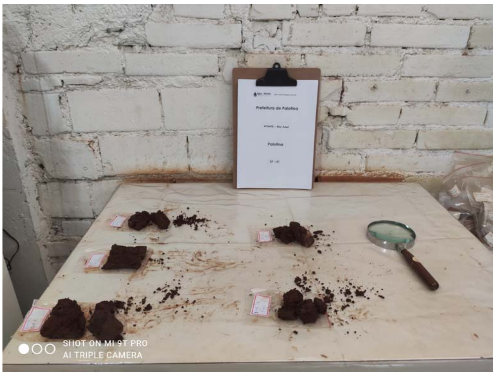
Foto 03 – Amostras do furo SP-01 dispostas para descrição. O topo se encontra no canto inferior esquerdo e a base, na porção central da mesa. Foto do autor.
