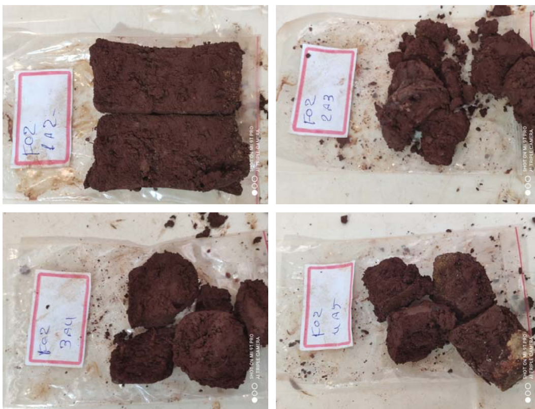
Fotos 04 a 07 – No alto, da esquerda para a direita = a) solo coluvionar; b) solos coluvionar com restos de madeiras em estado de decomposição; c) solo residual de rochas vulcânicas com textura maciça e d) solo residual de rochas basálticas com fragmentos da rocha matriz. Fotos do autor.
